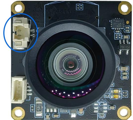
Die IR-Cut-Filterschnittstelle wird von Objektiven mit Filtern verwendet. Benutzer müssen das Objektiv anpassen, das die IR-Cut-Schalterstruktur unterstützt, um diese Funktion zu unterstützen. Dieses Modul unterstützt die IR-Cut-Funktion nicht.
