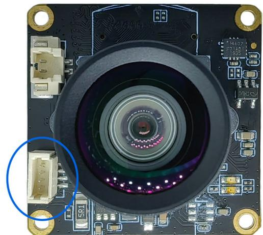
Die beiden Fülllichtschnittstellensätze unterstützen die Erweiterung von Infrarotlicht- und Weißlichtplatten, um das Gerät mit Fülllicht zu versorgen. Wenn Sie die Fülllichtfunktion benötigen, müssen Sie die KLT-LEDP V2.0-Weiß- und Infrarotlicht-LED-Platte hinzufügen.
